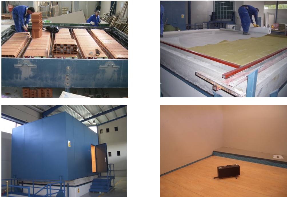
Figura 3. Ejemplo. Cámaras normalizadas de AUDIOTEC para ensayos de aislamiento acústico de cerramientos horizontales
