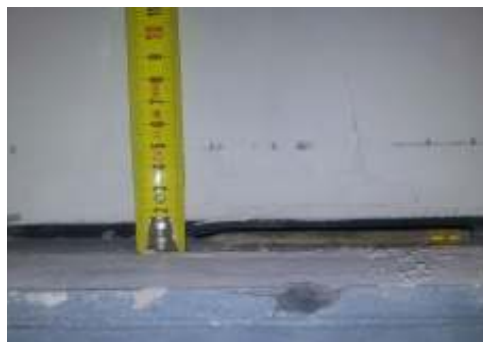
Figura 4. Abertura en la parte superior e inferior de la muestra. Ranura horizontal de 14mm de grosor.
