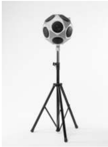
Figura 8. Fuente sonora omnidireccional situada sobre el trípode
