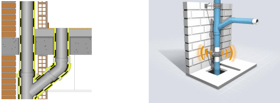
Figura 21. Sistemas antivibratorios para tuberías y bajantes en edificios
