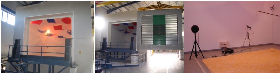
Figura 4. Ejemplo. Cámaras normalizadas de AUDIOTEC para ensayos de absorción acústica de materiales
