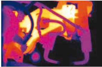
Punto caliente en robot de soldadura
