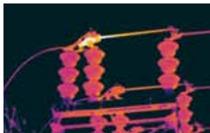
La inspección de una subestación revela componentes recalentados.
