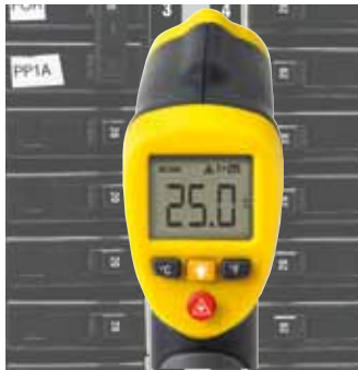
Termómetro de IR, medición de temperatura en un punto
