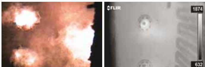
Algunas cámaras termográficas de FLIR pueden medir la temperatura tras las llamas.
